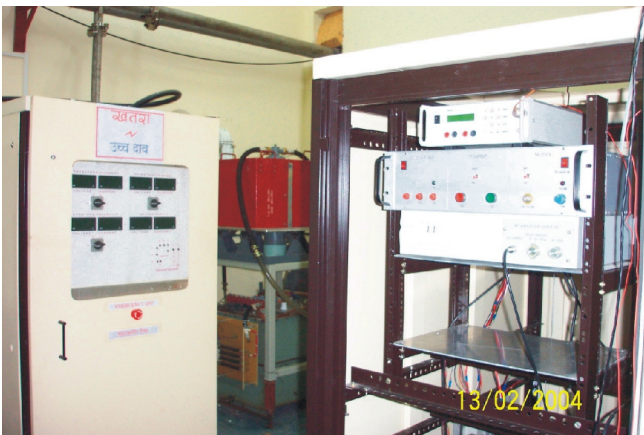
10 एमईवी लिनाक की उच्च शक्ति के लिए सूक्ष्म तरंग प्रणाली
