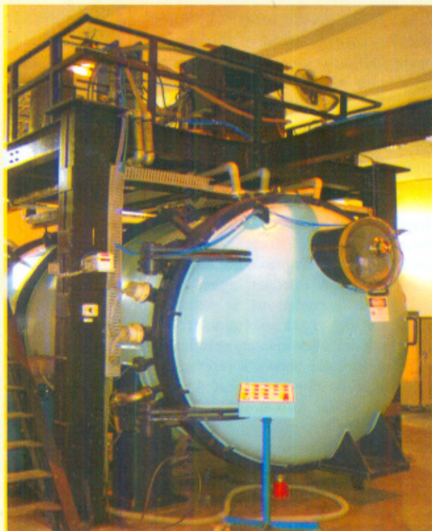
Fig. L.3. 2 20 kW CW CO 2 Laser
