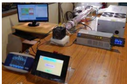
चित्र A.31(a): नियंत्रण प्रणाली के साथ नवीनीकृत ग्लास ट्यूब-आधारित CO 2 लेसर। Fig.A.31(a): Refurbished glass tube-based CO 2 laser with Control System.
