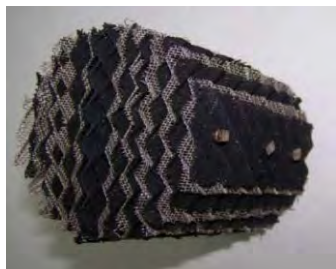
चित्र A.30(a): इकट्ठे संरचित पैकिंग उत्प्रेरक मॉड्यूल। Fig.A.30(a): Assembled structured packing catalyst module.
