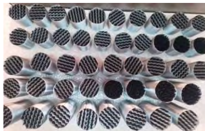
चित्र A.30(b): 45 नमूने तैयार संरचित पैकिंग उत्प्रेरक मॉड्यूल। Fig. A.30(b): 45 nos. of finished structured packing catalyst modules.
