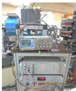
चित्र A.28: IRFEL सुरंग में तेज स्टीयरिंग चुंबक हेतु शक्ति आपूर्ति और इसकी धारा तरंग Fig. A.28: Fast steering magnet power supply in IRFEL Tunnel and its current waveform
