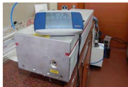
चित्र A.31(b): नवीनीकृत RF संचालित 150 W CO 2 लेसर हेड। Fig.A.31(b): Refurbished RF-powered 150 W CO 2 Laser Head.
