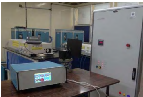
चित्र A.15: FF तारापुर में ईंधन पिन वेल्डिंग हेतु प्रदत्त 500 W औसत शक्ति और 10 kW स्पंदित शीर्ष शक्ति का ND:YAG लेसर Fig. A.15: 500 W average power and 10 kW peak power pulsed Nd:YAG laser for fuel pin welding at FF, Tarapur.
