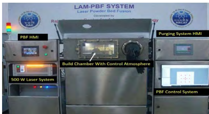
चित्र A.24: नियंत्रित वातावरण के साथ विकसित LPBF मशीन
