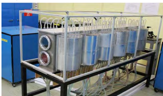
चित्र.A.18(a):12-डिस्क ND:ग्लास एम्पलीफायर असेंबली Fig. A.18(a): 12-disc Nd: Glass amplifier assembly
