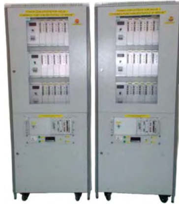
चित्र A.1: इंडस-1 संयुक्त फंक्शन मल्टीपोल मैग्नेट पावर कन्वर्टर
