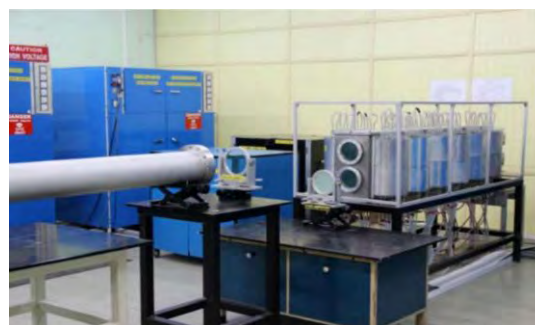
चित्र A.18(b):12-डिस्क ND:ग्लास एम्पलीफायर वैक्यूम स्थानिक फिल्टर के साथ Fig. A.18(b) :12-disc Nd: Glass amplifier with long arm vacuum spatial filter
