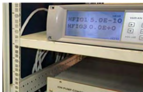
चित्र A.12(b): BA गेज नियंत्रक द्वारा दिखाया गया परम दाब Fig.A.12(a): Prototype SIP (20 lps) made of Al body in test setup
