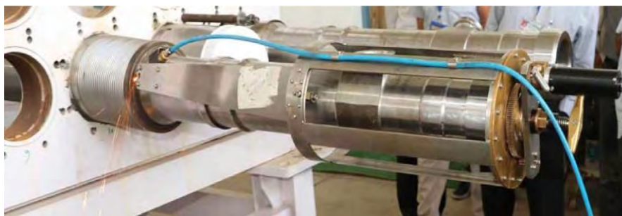
चित्र.A.32: RAPS -3 और 4 साइट पर बेलो लिप का लेसर कटिंग मॉकअप।
