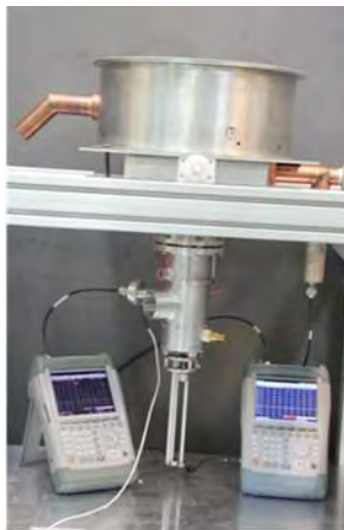
चित्र A.8: TH टेट्रोड आधारित 100 kW / 325 MHz आरएफ प्रवर्धक
